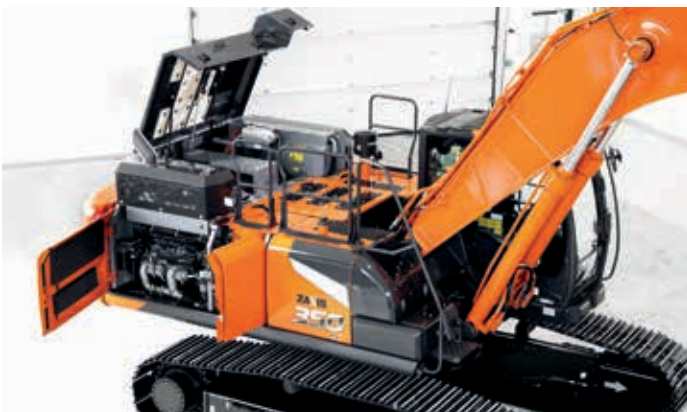
De motorkap met dempers (ZX300/ZX350) biedt eenvoudige toegang voor dagelijkse inspecties.
