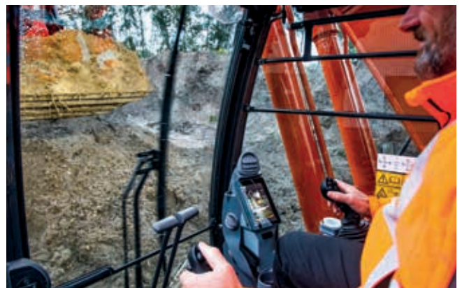
Parallelruitenwissers verbeteren het zicht.
